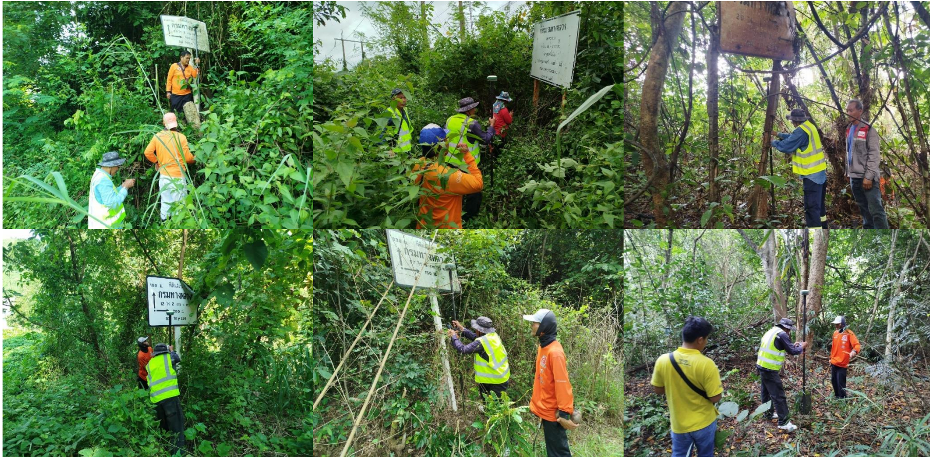
รูปที่ 2-2 การสำรวจจริงรังวัด และปรับปรุงแผนที่รูปแปลงที่ดินสงวนนอกเขตทาง โดยระบบโครงข่ายการรังวัดดาวเทียมแบบจลน์ (RTK GNSS Network)
